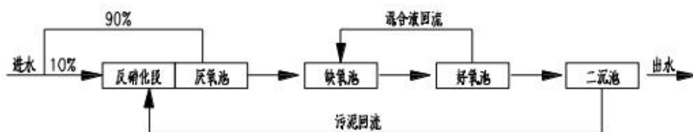
图 4.2-2 改良型 A/A/O 工艺流程
